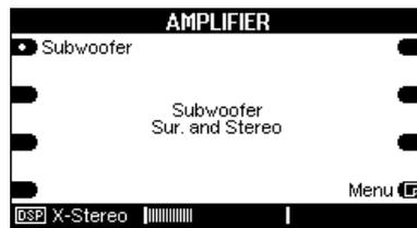
Dieser Modus wird empfohlen, wenn der aktive Subwoofer sowohl bei der Mehrkanalwiedergabe (Hall, Dolby Pro Logic, etc.) **und** im reinen Stereo-Betrieb arbeiten soll.
